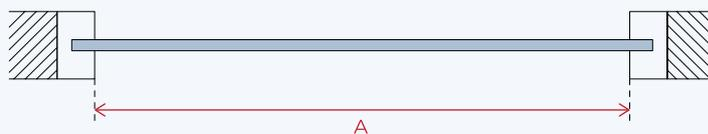
■ **BIT CHANFRADO OU REDONDO:** Se o bit for redondo ou chanfrado, medir a largura indicada pela medida A e medida B no desenho.
